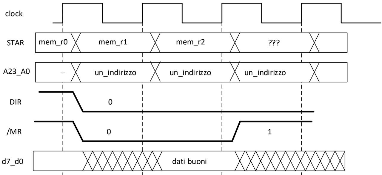
In `mem_r2`, se voglio, posso assegnare nuovamente `A23_A0` (ad esempio, per continuare la lettura ad un altro indirizzo). `DIR`, invece **non lo posso portare a 1**, in quanto le porte tri-state della RAM vanno in alta impedenza **un po' dopo il fronte di salita di `/mr`**. Quindi, se portassi subito `DIR` a 1, si rischierebbe un problema elettrico (anche se transitorio). In realtà `DIR` conviene tenerlo sempre a 0, tranne che durante le operazioni di scrittura.
