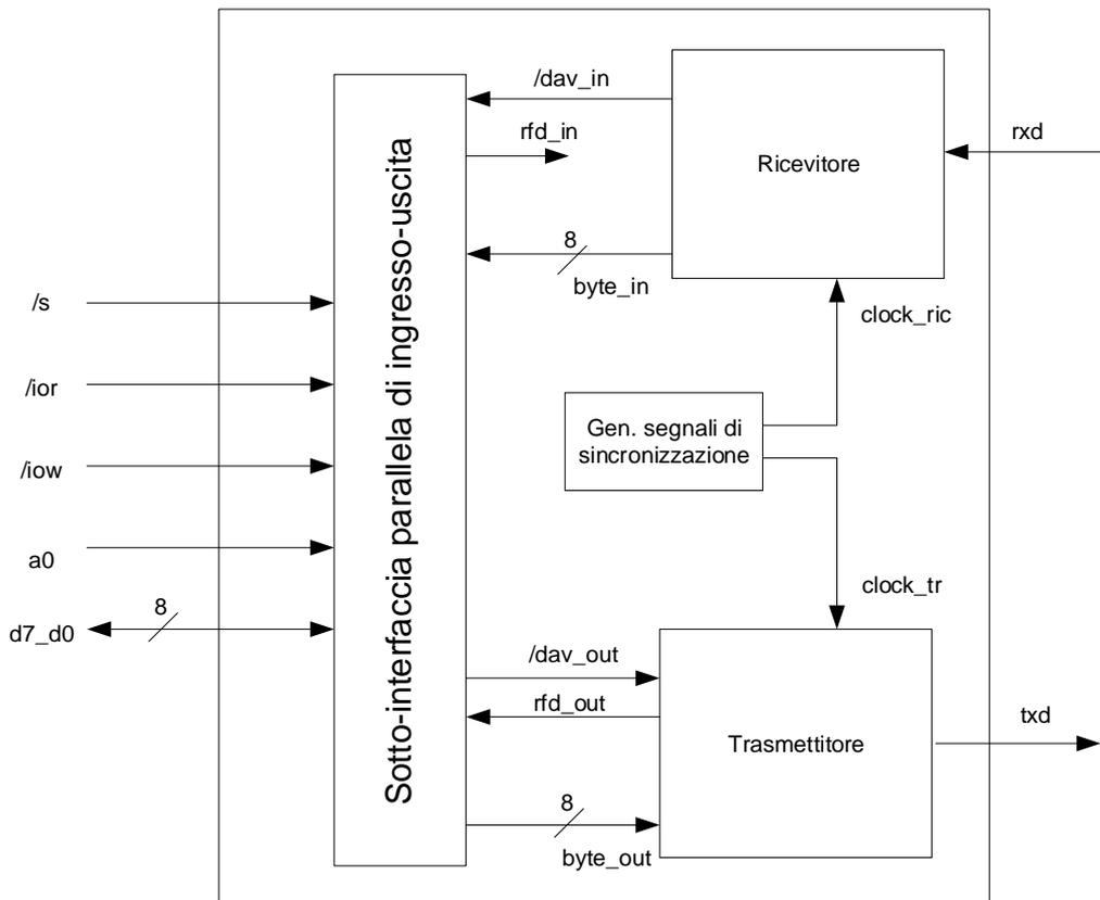
C'è una **sottointerfaccia parallela di I/O con handshake**, che colloquia con due **due reti sequenziali sincronizzate**, dette trasmettitore e ricevitore. Cominciamo a descriverne una. Si parte dal trasmettitore.
