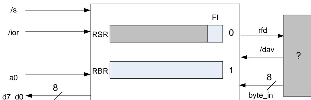
La RC interna deve, per prima cosa, generare i segnali di abilitazione per le tri-state quando il processore accede in lettura a RBR o RSR. Le due tri-state (una delle quali ha 8 bit) non sono mai in
