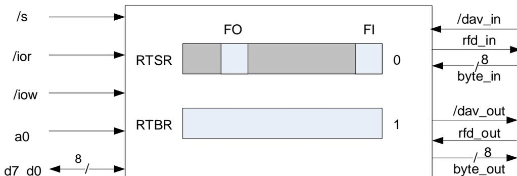
In questo caso, i due registri RBR e TBR sono mappati sullo stesso indirizzo interno, e sono acceduti rispettivamente in lettura e scrittura. I due flag FI e FO danno corpo a due bit in un unico registro di controllo, detto RTSR. Dal punto di vista della descrizione interna dell'interfaccia, le cose stanno in questo modo:
