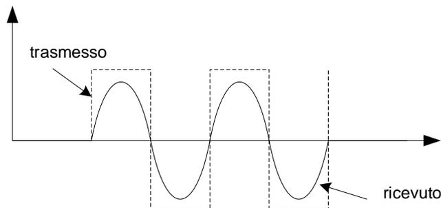
Se devo poter ricevere e decodificare correttamente  $n$  bit tra due **segnali di sincronizzazione successivi** (bit di start), **cercando di campionarli nel mezzo**, è necessario che:  $n \cdot \Delta T \leq \frac{T}{2}$ , cioè che
